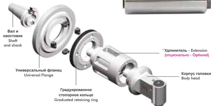
Это серия головок для обычных станков с креплением через фланец. Т-образный паз на фланце позволяет позиционировать головку на 360° вокруг вертикальной оси. Модульная система позволяет увеличить длину добавлением проставки. Удлинитель, хвостовик и фланец имеют модульную конструкцию и поэтому взаимозаменяемы между всеми головками аналогичного размера.
