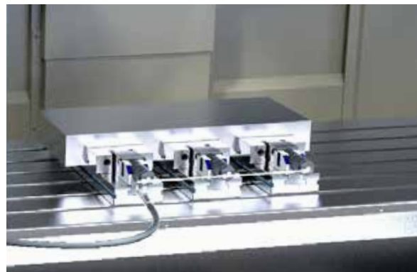
Mordazas modulares de precisión acoplables y alineables para sujeción neumohidráulica múltiple
