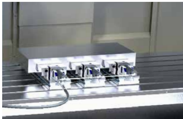
可以耦合和对齐的精密模块化虎钳 用于多个气动液压夹紧
