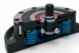
La funzione DOPPIO EFFETTO, possibile con zero point singoli (ermetici), permette di ottenere parametri di serraggio notevolmente superiori rispetto al normale funzionamento grazie alla valvola di non ritorno. Quando è azionata l'aria compressa aggiunge una forza pneumatica in supporto al normale sistema di serraggio tramite molle.
