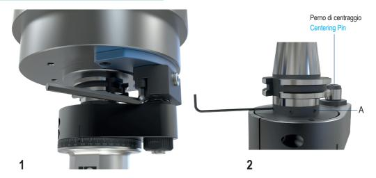
Per disporre lo stop-block all' esatta distanza dell'asse mandrino e per sistemare l'orientamento del cono rispetto al perno di fermo. Agire come seque:
