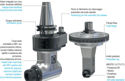
Ciascun albero di trasmissione supportato da cuscinetti a contatto obliquo, che garantiscono rotazioni dell'albero-cono e dell'uscita portautensile entro 0.01 mm Each transmission shaft is supported by slanting bearings that ensure the shaft with shank and the toolholder output rotations within 0,01mm.
