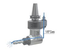
Nelle teste angolari G90.. ATC B, l'adduzione del liquido avviene sempre dal perno di indexaggio, tramite un tubo che lo porta al centro dell' utensile tramite il distributore rotante (A). MAX 10 BAR
