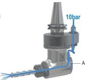
Nelle teste angolari G90.. ATC RI, l'adduzione del liquido avviene dal cono, attarversando il corpo testa e tramite il distributore rotante arriva al centro dell' utensile.
