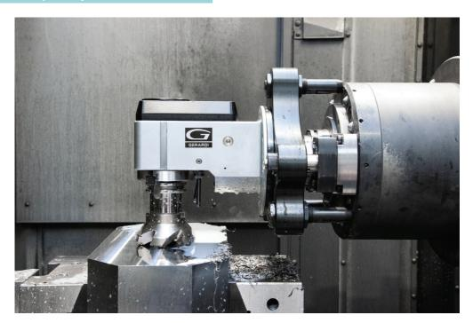
Esempi applicativi di teste angolari Classic con montato il sistema antirotante MULTIPOINT. Il sistema MULTIPOINT è composto da 3 punti d'appoggio aggiuntivi oltre al perno antirotazione, garantendo così una maggiore stabilità e consentendo lavorazioni pesanti con minor vibrazioni
